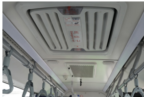
비상탈출용 천장 비상구
