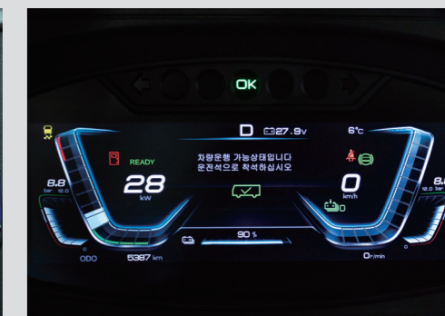
12.3인치 대형 LCD 클러스터 (운전석 좌석이탈 경고기능 포함)
